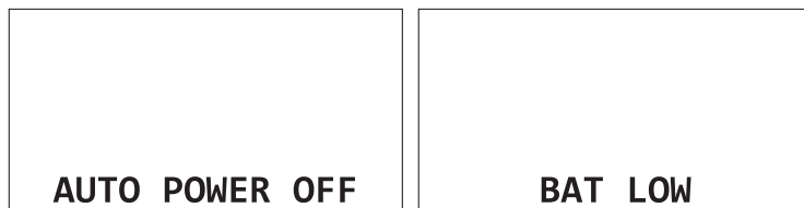
Fig. 4: Desconexão automática: A barra de teste não foi operada durante vinte minutos (esquerda) A capacidade restante da bateria é demasiado baixa (direita)
