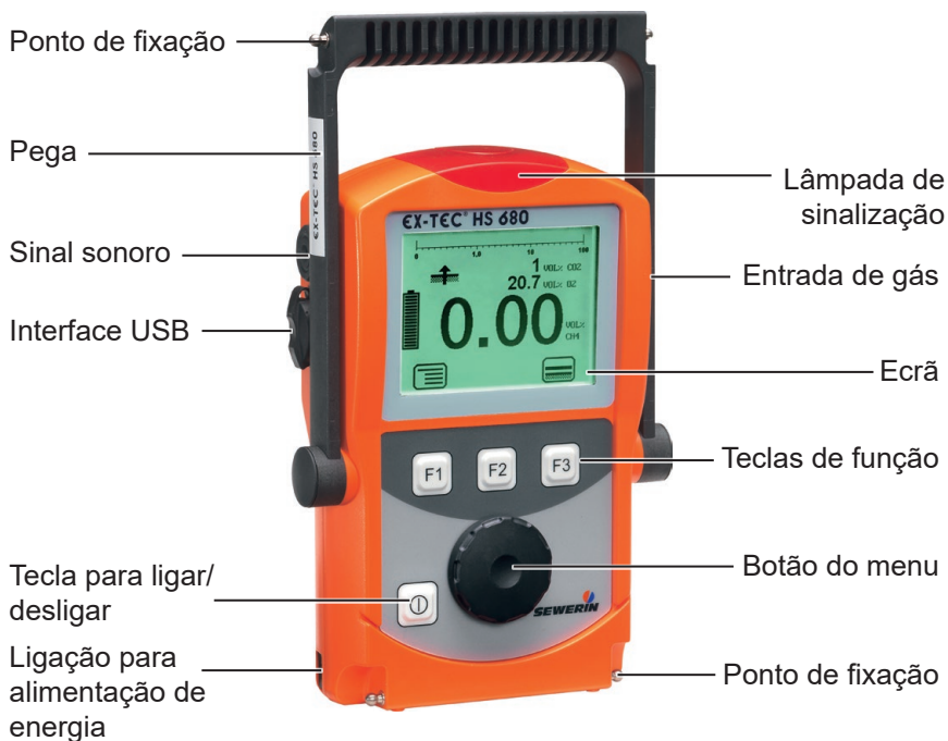
Fig. 1: Vista geral do aparelho EX-TEC HS 680
