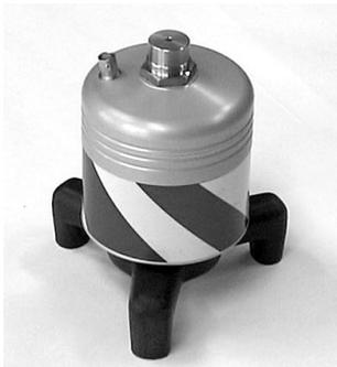
O microfone de solo 3P-4 é usado na deteção de fugas em superfícies terrestres não fixas. Para solos moles pode ser aparafusada uma estaca própria para solo. Os 3 pés garantem sempre um contacto estável.
