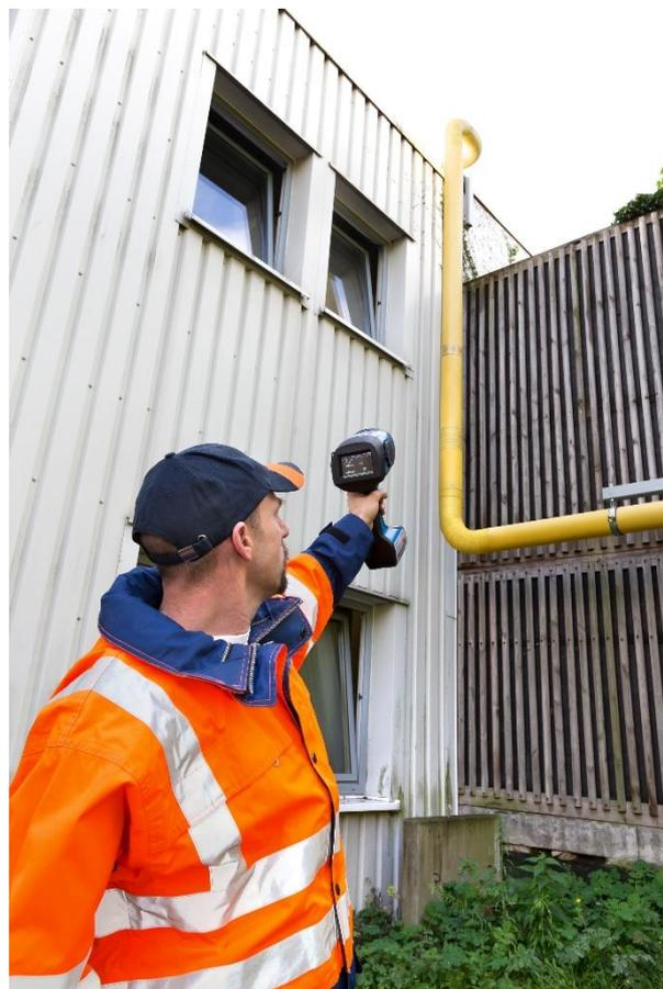
É importante notar que este sistema de medição não tem qualquer sensibilidade cruzada com qualquer outro hidrocarboneto, nem apresenta indicações errôneas devido a fumos, umidade, etc. Só reage com metano. É, portanto, altamente confiável.
