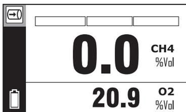
Fig. 24: Modo de medição (*aqui*: Aplicação **Medição**) do lado superior esquerdo (área de informação): Símbolo da aplicação atual
