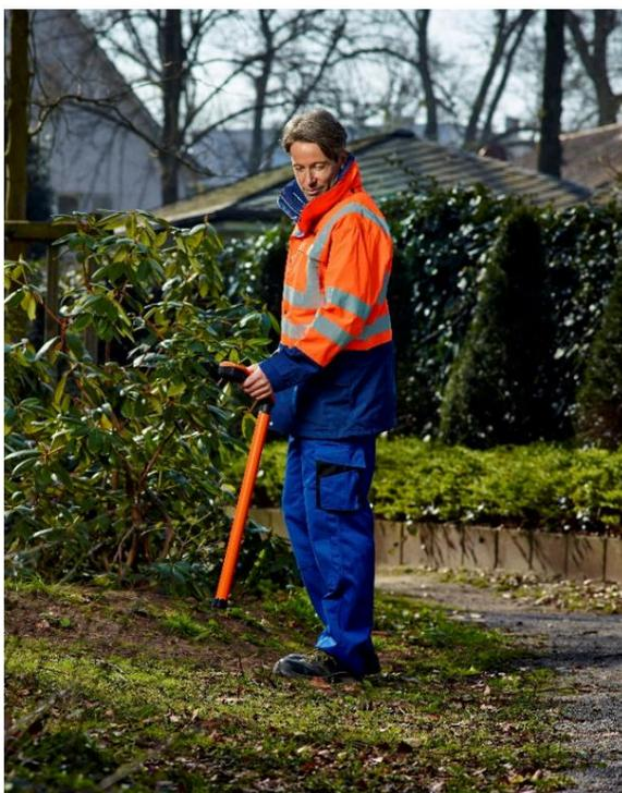
Ao tentar localizar tampas de bueiros, válvulas ou qualquer elemento metálico de uma rede de distribuição (água, gás, etc.), muitas vezes são produzidas leituras falsas devido à presença de outros elementos metálicos, como latas de refrigerantes, folhas de alumínio, etc.
